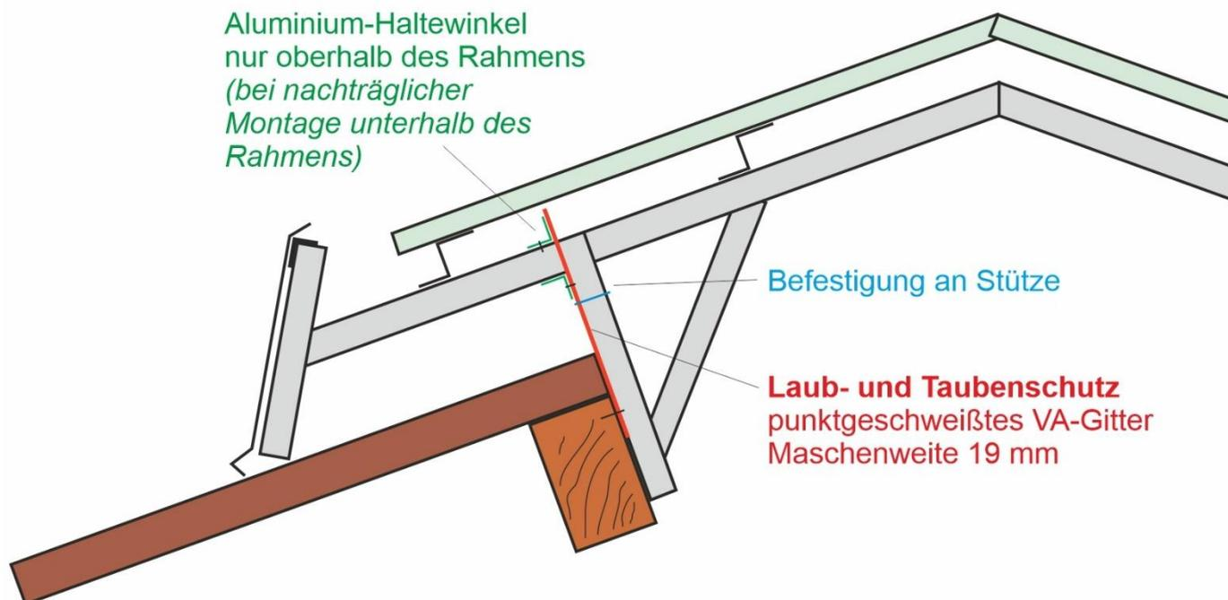
Das **Laub- und Taubenschutzgitter** für die Müller Licht- und Lüftungsfirste besteht aus Edelstahl und wird zwischen den Stützen des Firstes montiert.
