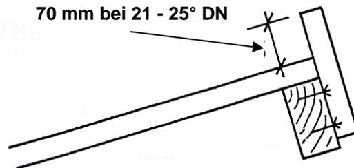
2. Schnur spannen und alle anderen Stützen ausrichten und ebenfalls mit je zwei Bohrerschrauben befestigen. Der Stützenabstand beträgt beim Deluxe compact **1440 mm** (Mitte Stütze bis Mitte Stütze).
