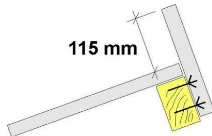
2. Schnur spannen und alle anderen Stützen ausrichten und ebenfalls mit je 2 bzw. 3 Bohrerschrauben befestigen. Der Stützenabstand ist unbedingt einzuhalten und beträgt beim Deluxe Cavallo **MLL 60 bis 200 - 1440 mm** (Mitte Stütze bis Mitte Stütze) und beim **MLL 225 bis 400 - 960 mm**.
