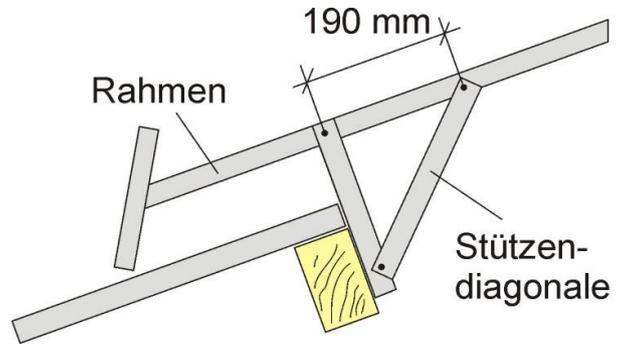
5. Al-Z-Pfetten gemäß Skizze auf den Rahmen legen und pro Auflager mit zwei SX5 Bohrschrauben befestigen. Die Überlappung der Pfetten beträgt 120 mm und befindet sich genau auf einem Rahmen. Achten Sie auf die richtige Firstgröße und Anzahl der Pfettenreihen pro Seite.
