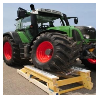
Der Härtestest – biaxial gereckte Lichtplatte gegen Traktor
