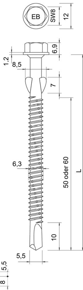
**Bild 2.10: END DDBS FK B 6,3 x L für Stahl-Unterkonstruktionen**
