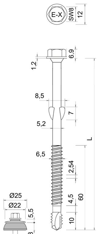
**Bild 1.3: END E-X DDBS FK A 6,5 x L**
