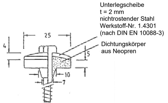
Bild 2.2: Dichtungskörper und Unterlegscheibe
