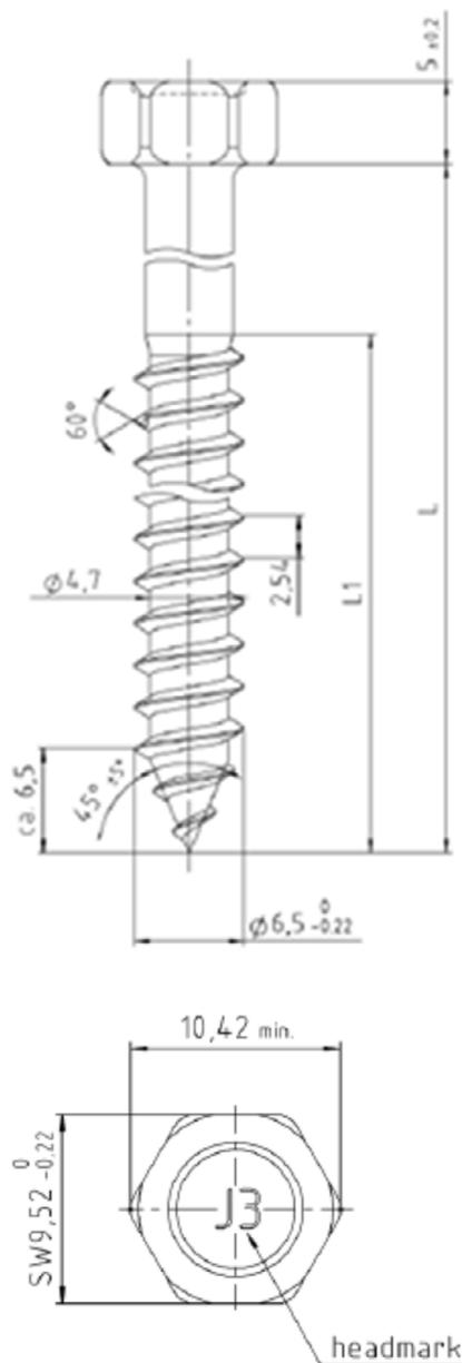
**Bild 1.1:** Sechskant-Holzschraube EJOT JA3-6,5 x L
