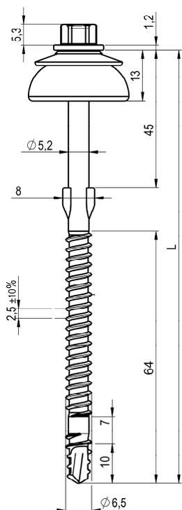
**Bild 2.7: REISSER WFBS-V-A 6,5 x L**
