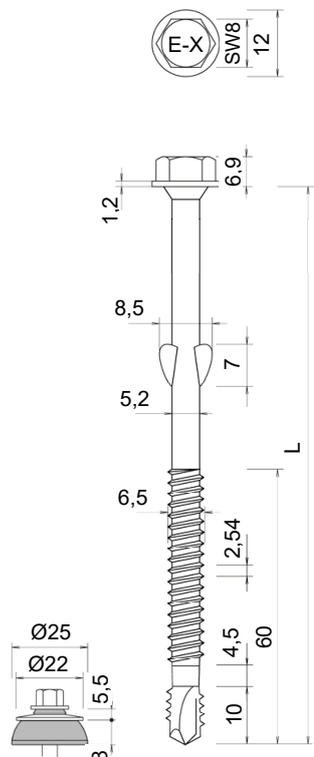
**Bild 2.5: END E-X DDBS FK A 6,5 x L**
