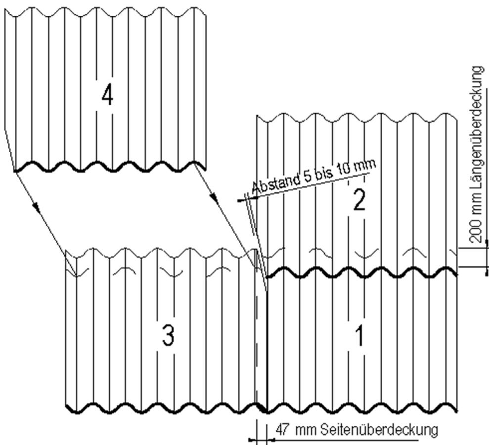
Bild 3.1: Überdeckung und Eckschnitte der Wellplatte **P5** und **P6**
