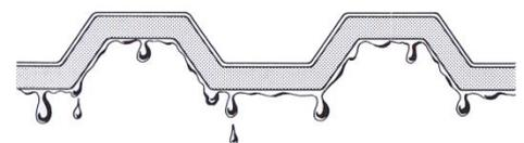
Das Tropfschutzvlies ist eine auf der Unterseite der Trapezprofile aufgebraute feuchtigkeitsabsorbierende Schicht.
